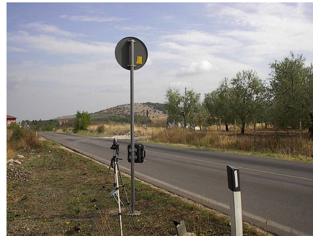
Figura 4: rilievo sincronico telecamera - radar
