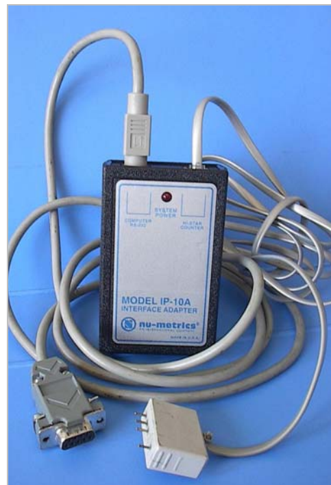
Figura 4 - Interfaccia IP 10-A e cavi per la connessione tra i contatraffico HI-STAR ed il computer
